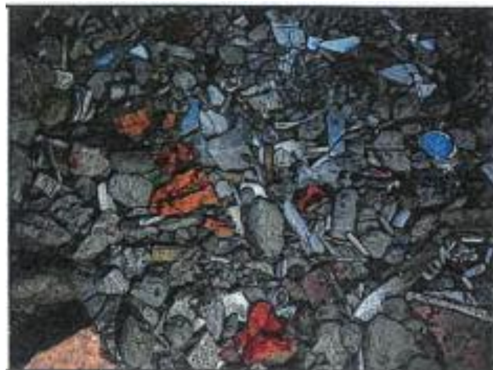
夾雜廢水管、生活垃圾、鋼筋
