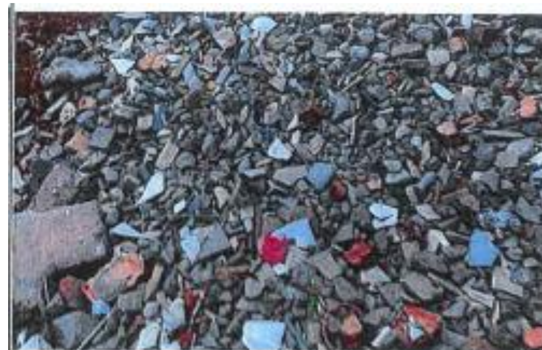
發現該地鋪設營建混和物於表面
