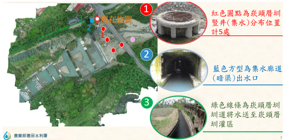
圖A、崁頭厝圳集水豎井分布示意圖
