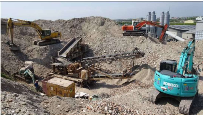
114年3月28日先經震動篩，再使用破碎機(違反作業程序)
