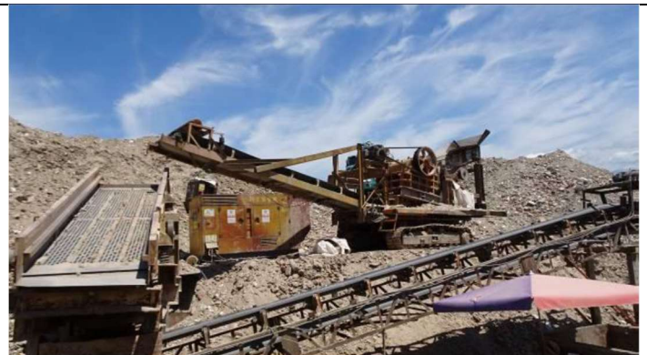
114年4月17日先經震動篩，再使用破碎機(違反作業程序)
