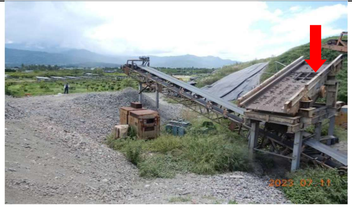
112年7月11日震動篩上有明顯破洞
