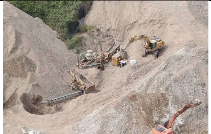
114年2月19日由左而右為輸送帶、震動篩、破碎機(缺少磁選機，違反作業程序)
