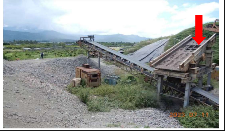
112年7月11日震動篩上有明顯破洞
