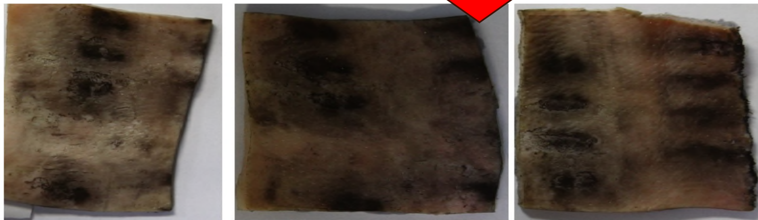
圖 33 豬皮包覆 T65K2 步槍防火帽射擊三重複之結果。
