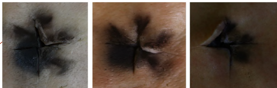
圖 1 以 T65K2 步槍在-1 公分距離處射擊豬皮三重複之結果。
