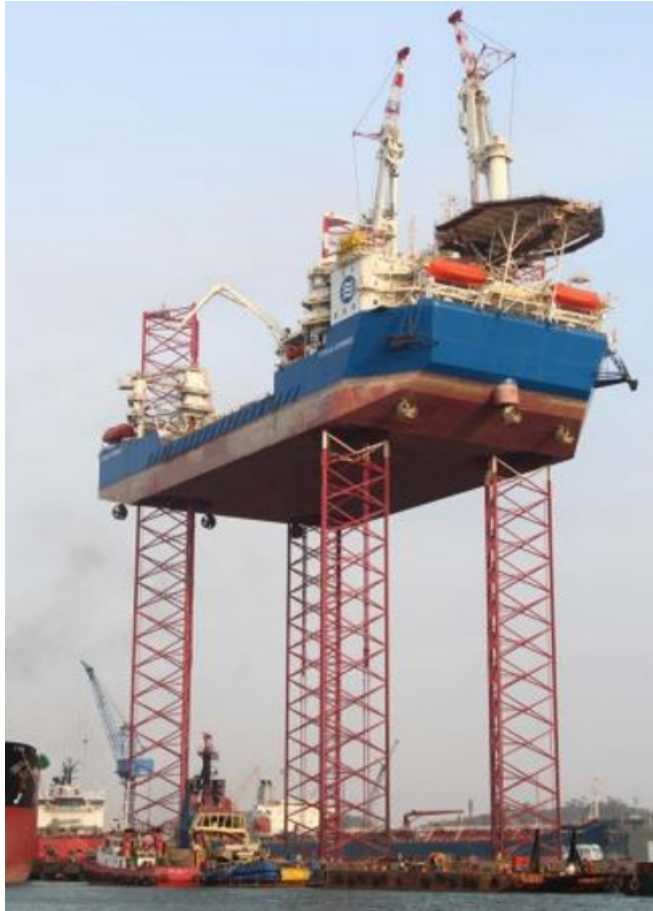
圖4 Ezion旗下原有自升式平台船（圖片來源：WindTAIWAN）
