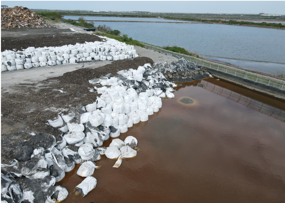
圖11 飛灰未妥善堆置四處散落
