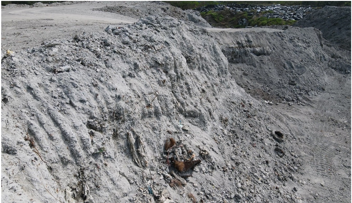
圖5 底渣未確實篩分，仍混有許多大型金屬物 資料來源：臺南社區大學環境小組113年11月24日攝。
