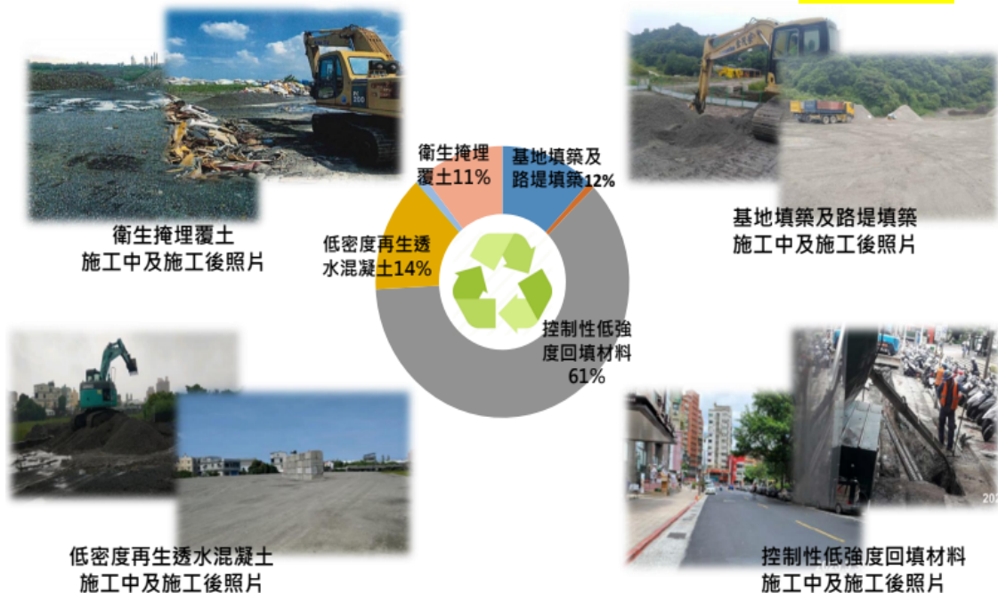
圖1 底渣再生粒料去化使用途徑圖
