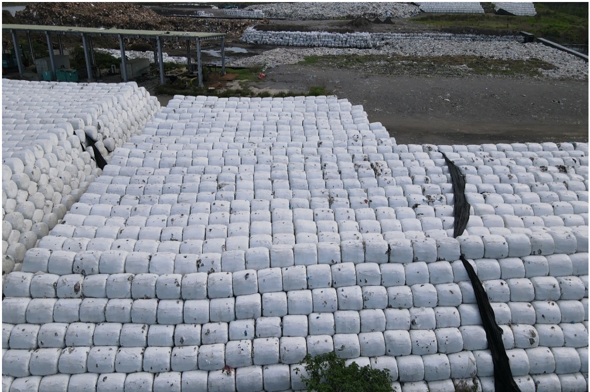
圖9 飛灰及底渣鄰近堆置及微粒造成揚塵
