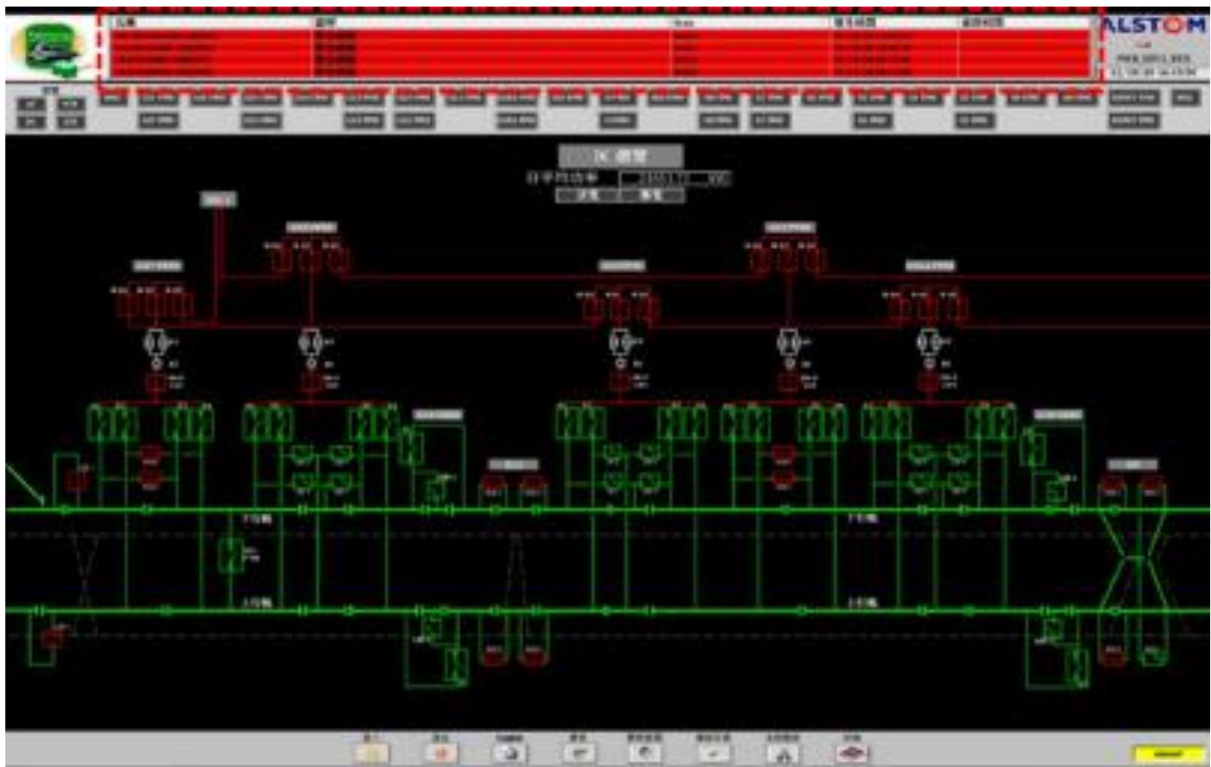
圖20 PWR SCADA 頂部橫幅告警顯示
