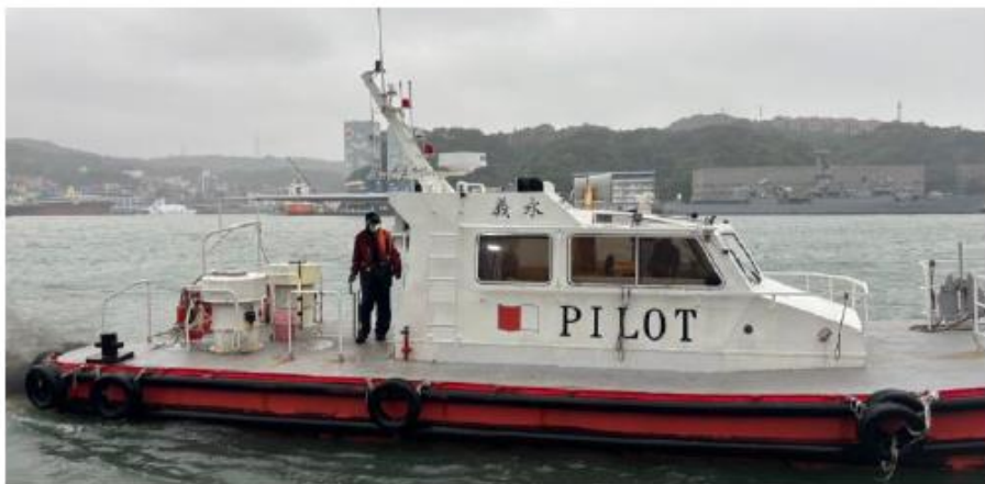
基隆港引水船永義號船齡1年、主機雙俾、設備探照燈1具、登離輪扶手欄杆
