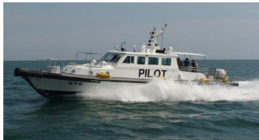
韓國釜山港引水船 Dongdumal 船齡14年、材質FRP、17噸、船速22節、設備：VHF3部、雷達1部、AIS1部
