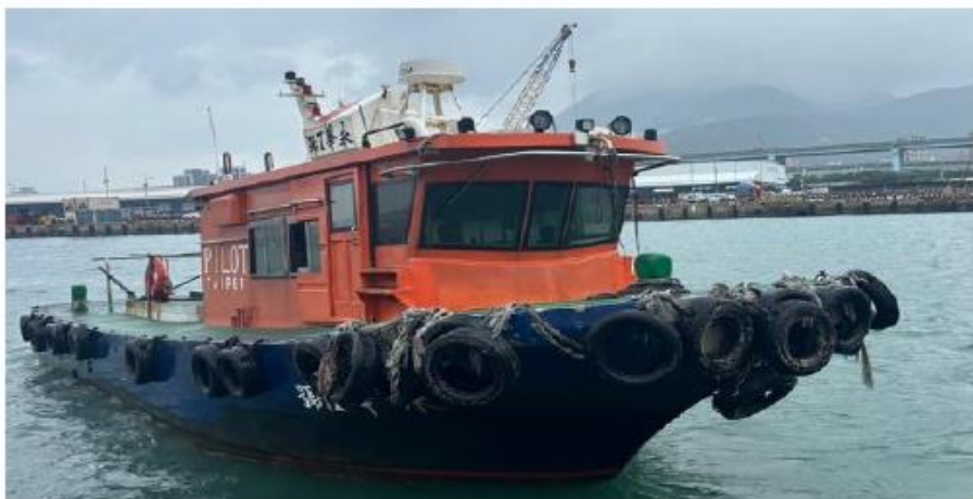
臺北港引水船永華7號船齡3年、主機單俾、設備探照燈1具、登離輪扶手欄杆、延伸踏板
