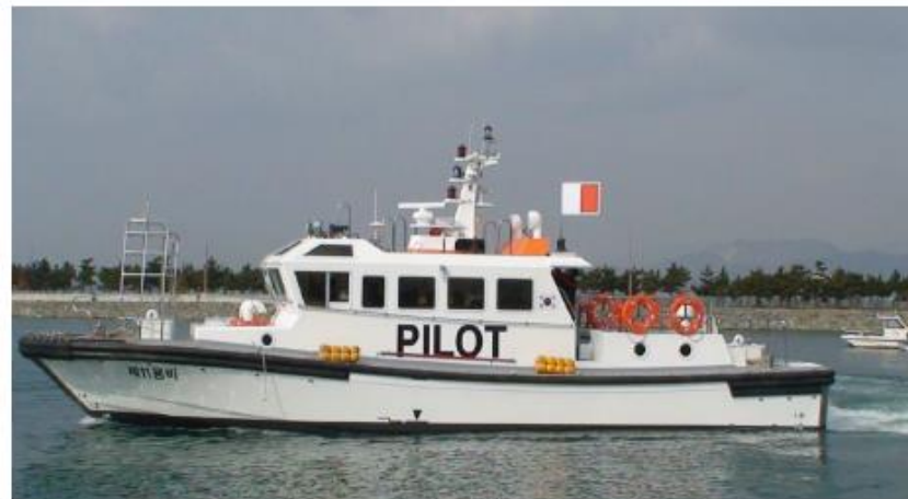
韓國麗水港引水船 11 Yongbi 船齡12年、材質FRP17噸、船速21節 VHF3部、雷達1部、AIS1部
