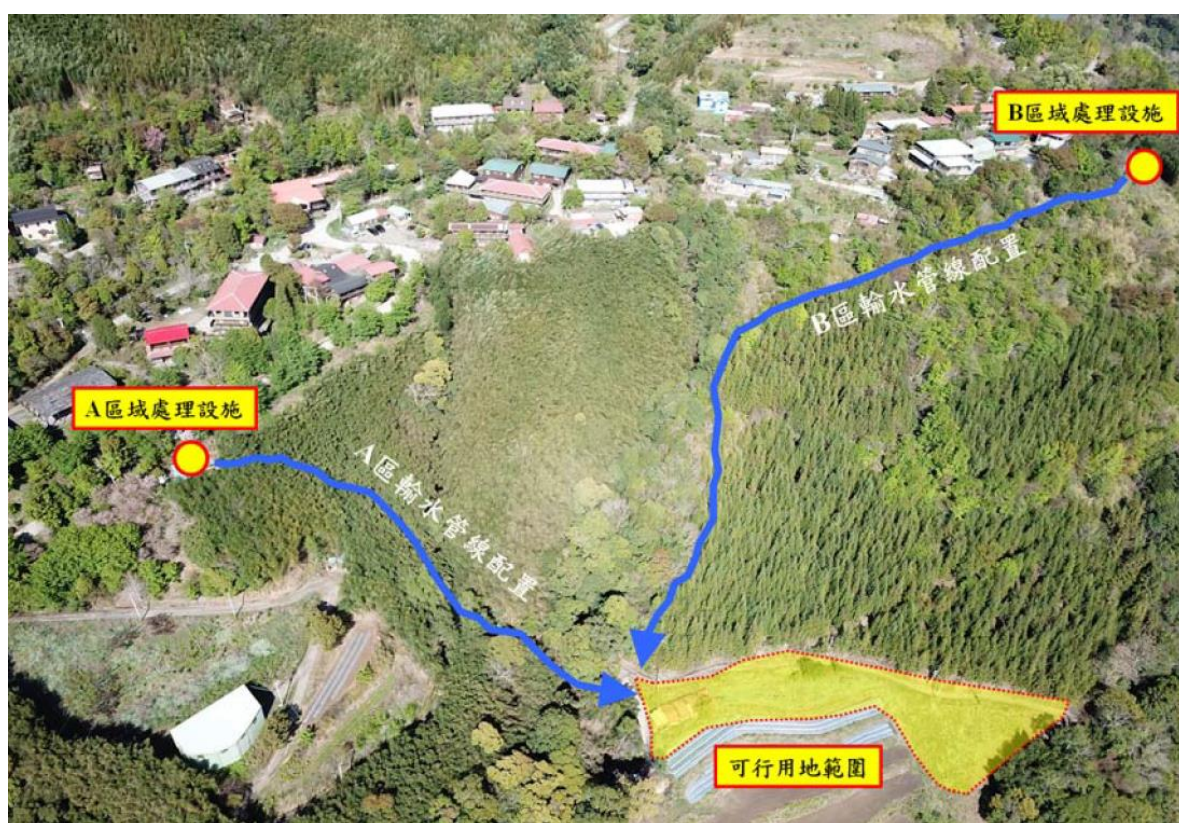
圖A 未來A、B區集水管線配置圖
