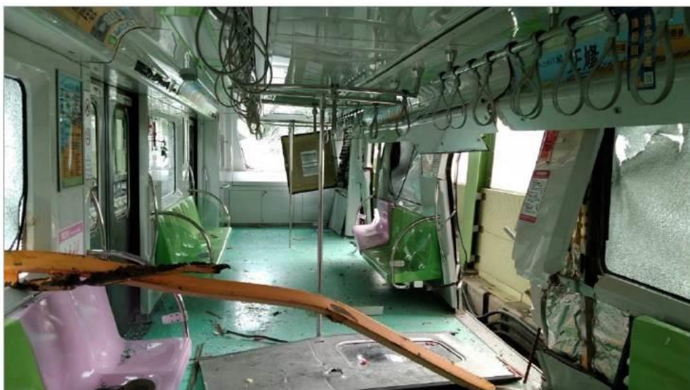
圖3 事故列車車門脫落
