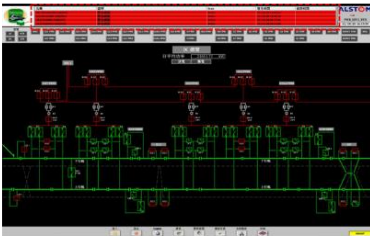
圖20 PWR SCADA 頂部橫幅告警顯示
