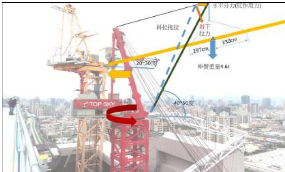
圖15 拆除機吊臂受力圖
