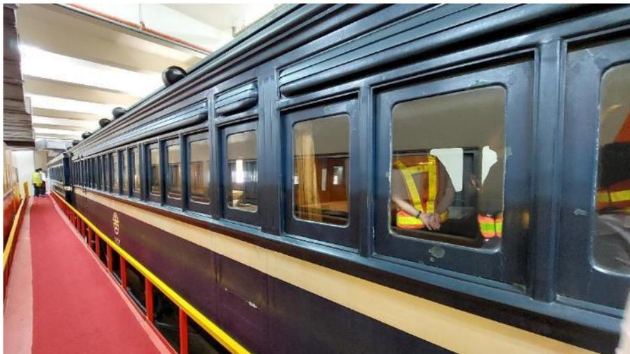
長13.9公尺、寬2.6公尺、高3.4公尺，空重20公噸，西元1904年完工，臺北鐵道工廠製造
