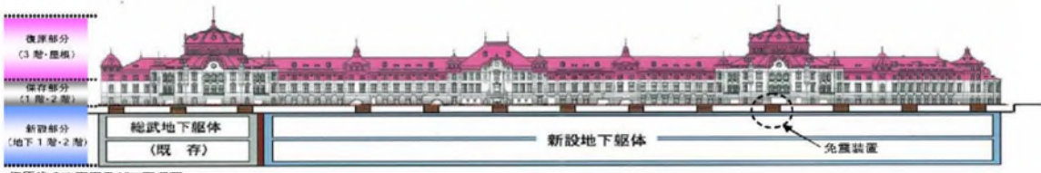
復原後の立面図及び工事概要
