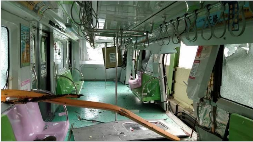
圖3 事故列車車門脫落
