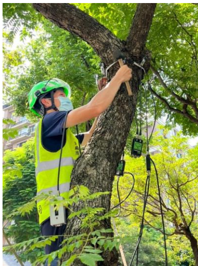
應力波檢測高處斷面
