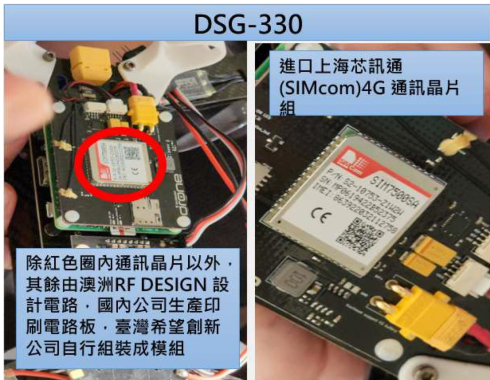
圖1 DSG330使用上海芯訊通(SIMcom)4G 通訊晶片組情形。(數位部提供)
