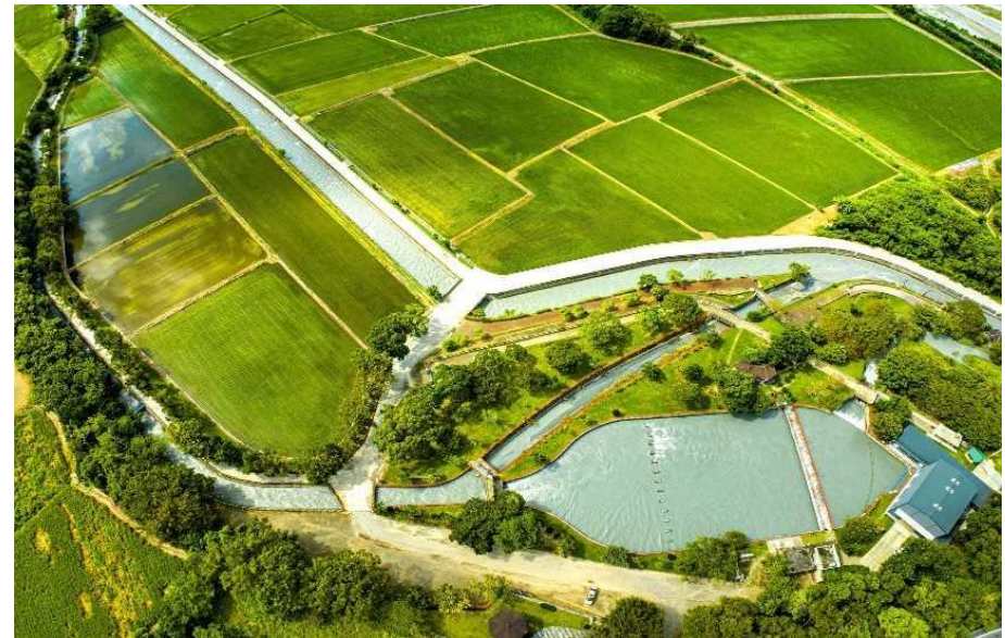
發電後尾水回流至關山圳幹線，灌溉農田
