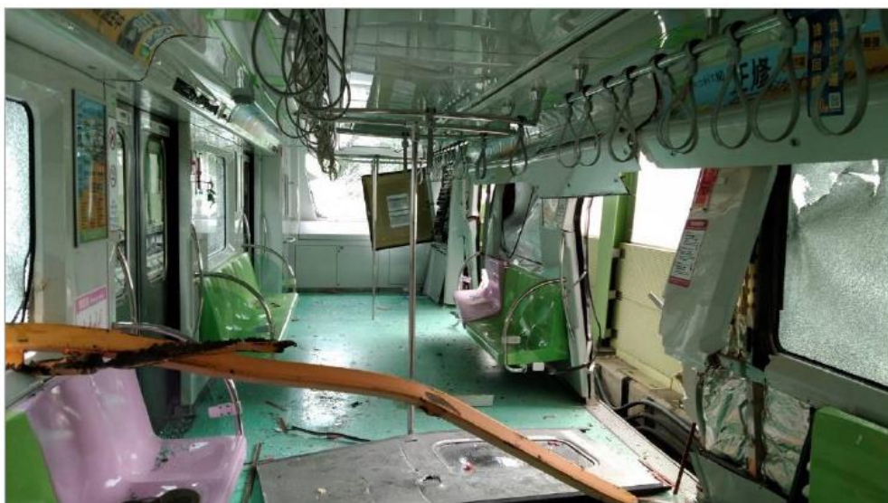
圖3 事故列車車門脫落
