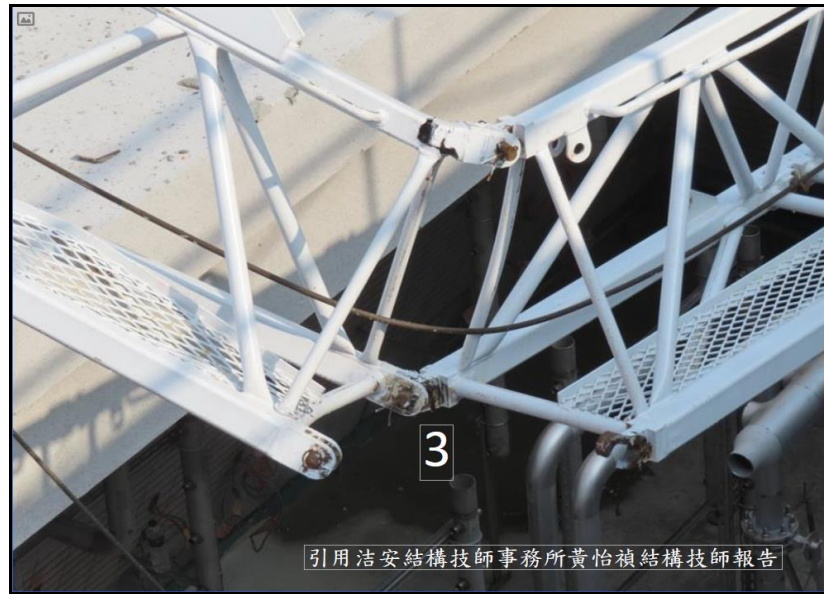
照片2 破壞點(3)伸臂掉落時撞擊屋頂時折斷
