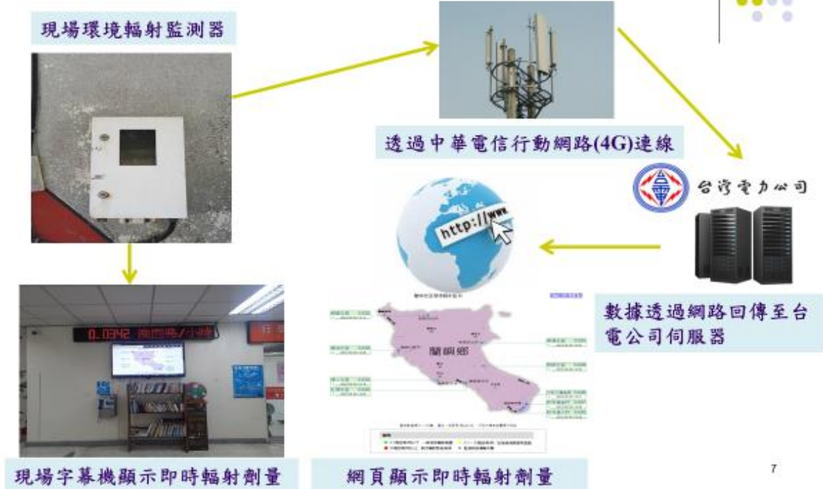
圖6 蘭嶼地區環境輻射監測系統示意圖
