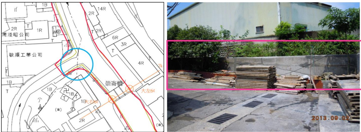
(a) 二號排水溝末端劃入大武崙溪區排堤線段，基隆市政府於102年完成護岸加高工作之區段（資料來源：基隆市政府簡報）
