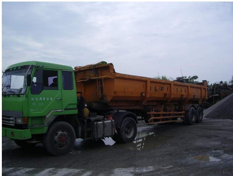
圖 4 鹿原砂石場主要使用之 35 噸重砂石車車型（第八河川局提供照片；參照臺北市交通管制工程處全球資訊網，此車型車身總長約 13~15 公尺）。
