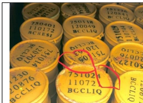
部分儲存桶位移和上下推擠，造成變形扭曲的情形
