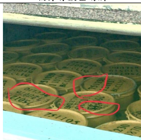
部分儲存桶位移和上下推擠，造成變形扭曲的情形
