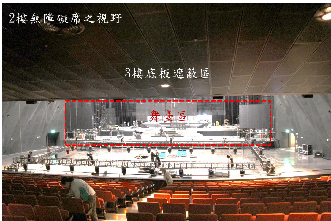
圖3 本院履勘照片1：本案無障礙席之舞臺觀賞視野，受3樓底板遮擋僅達紅色虛線（仰角4度）
