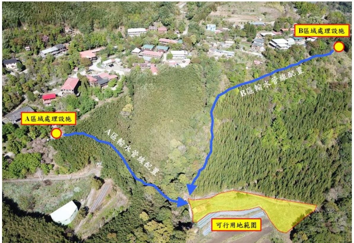
圖A 未來A、B區集水管線配置圖
