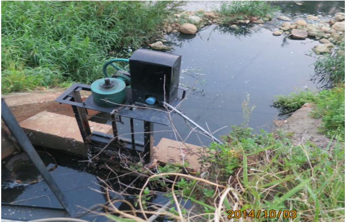
照片五、桃園觀音工業區於富林溪上游廢（污）水排放出水口之水質監測情形 I
