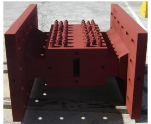
圖1 Type A及Type C 減振連接器外觀圖
