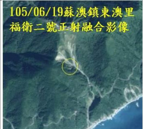
圖35. 福衛五號在蘇澳鎮東澳里之影像(左)與福衛二號105年6月19日同一地區之影像(右)互相比對，可發現有多處變異點，圈起處疑似為新增的崩塌地，經計算約為0.74公頃。
