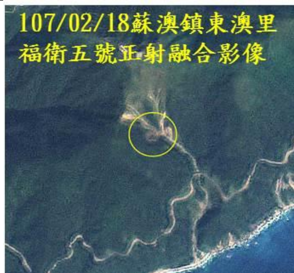
圖35. 福衛五號在蘇澳鎮東澳里之影像(左)與福衛二號105年6月19日同一地區之影像(右)互相比對，可發現有多處變異點，圈起處疑似為新增的崩塌地，經計算約為0.74公頃。
