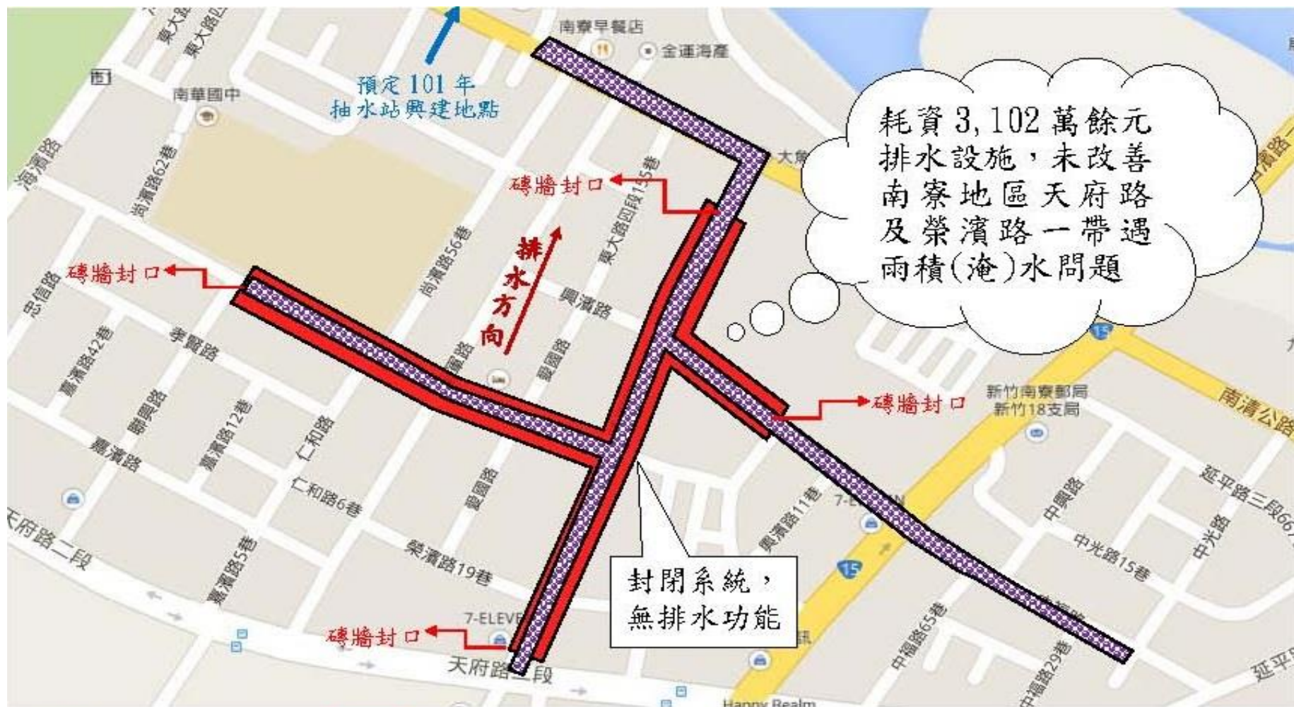
附圖 2 「新竹市南寮地區雨水下水道新建工程」未發揮應有排水功能示意圖
