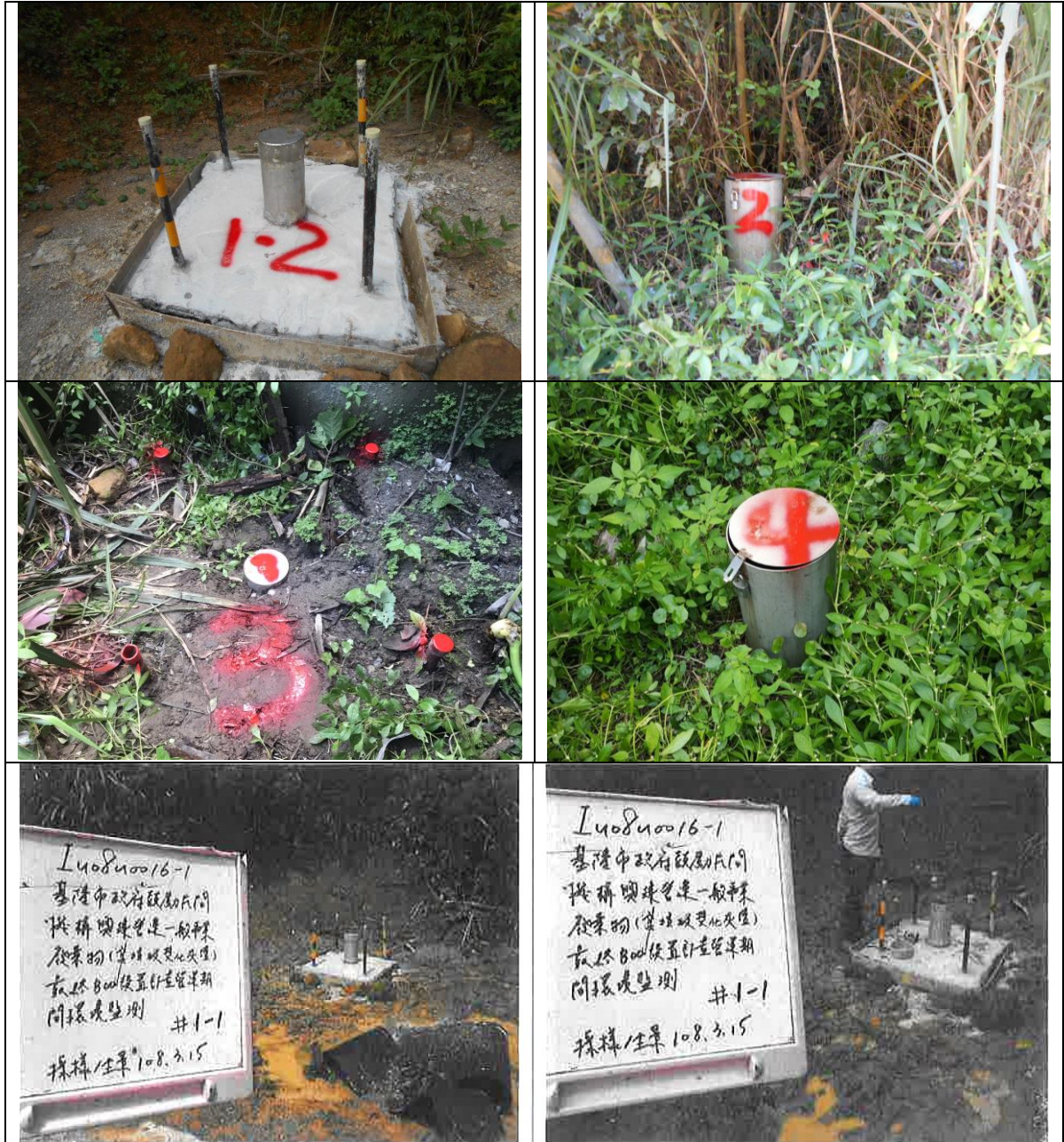
圖4 系爭處置場地下水監測井及採樣情形
