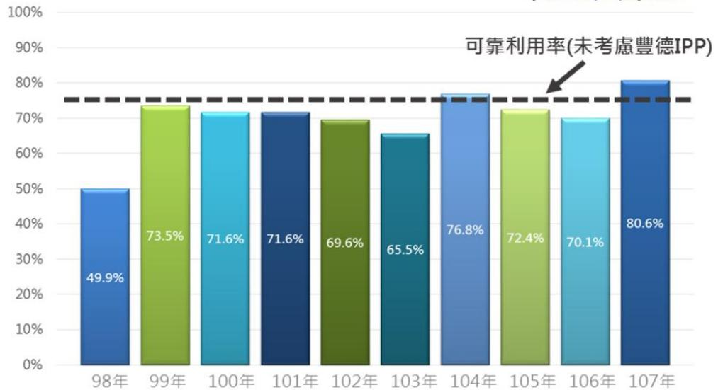
圖17 龍崎北超高壓主變壓器利用率
