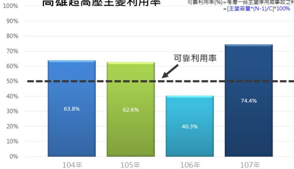
圖18 高雄超高壓主變壓器利用率
