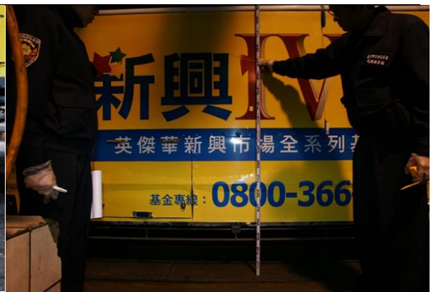
相片2. 甲公車左側車身中段刮擦痕跡距地高度量測與標示
