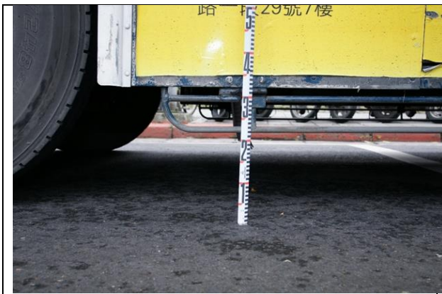
相片1. 甲公車左前輪後方防捲入護欄距地高度量測情形
