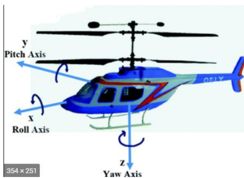
圖4 俯仰角(PITCH)、翻滾角(ROLL)及偏航角(AZIMUTH)
