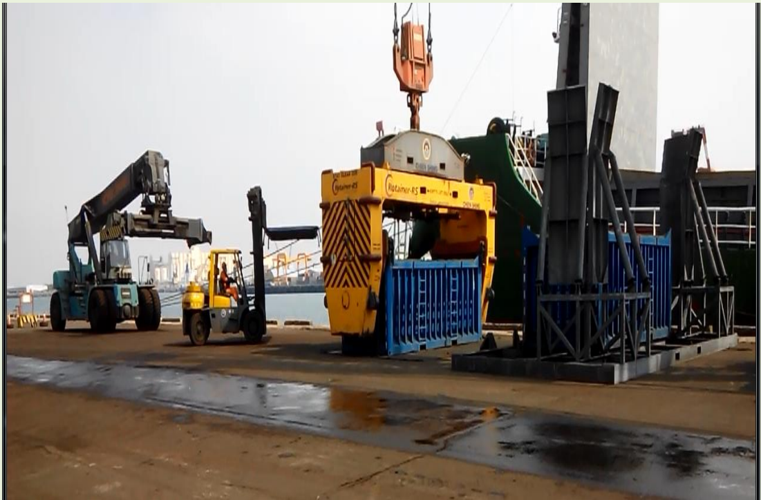
圖3 銅土出口裝船作業（圖左空櫃落地，圖右重櫃定位待吊入艙。） 資料來源：臺灣港務公司臺中分公司
