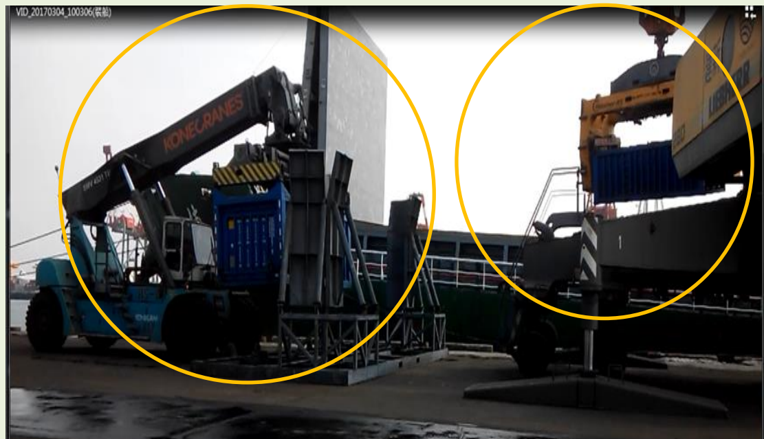
圖2 銅土出口裝船作業（圖左重櫃藉導正架就定位，圖右空櫃吊出艙。）
