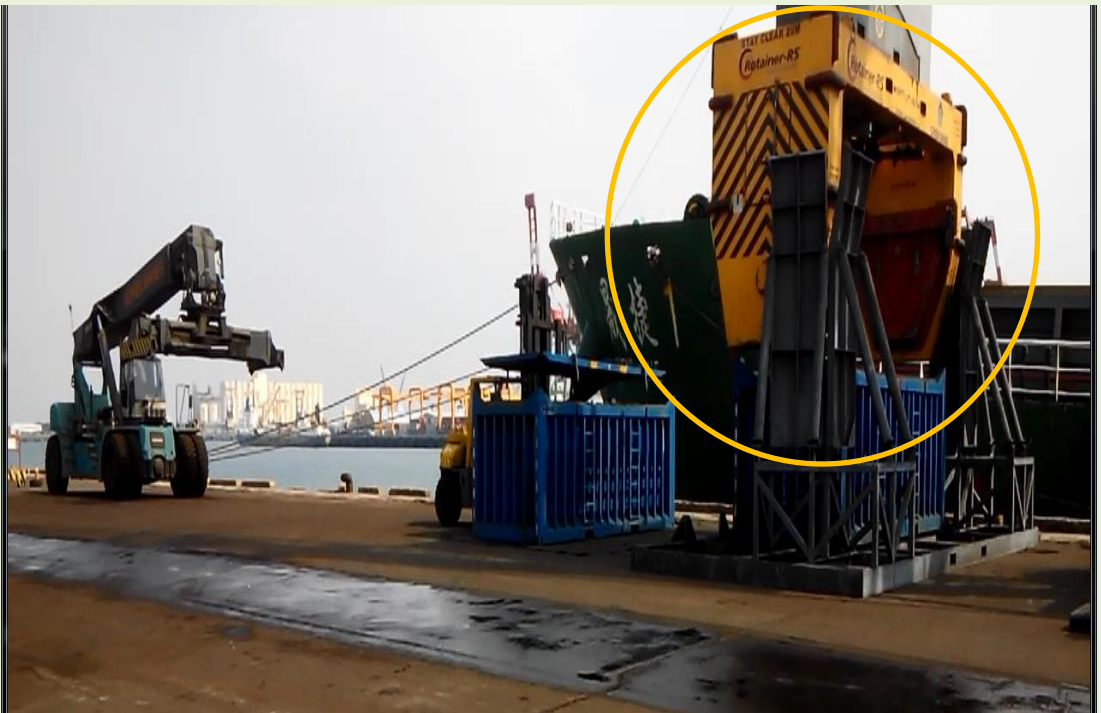
圖4 銅土出口裝船作業[夾具（圈示處）藉導正架，將重櫃夾緊後吊入船艙。] 資料來源：臺灣港務公司臺中分公司
