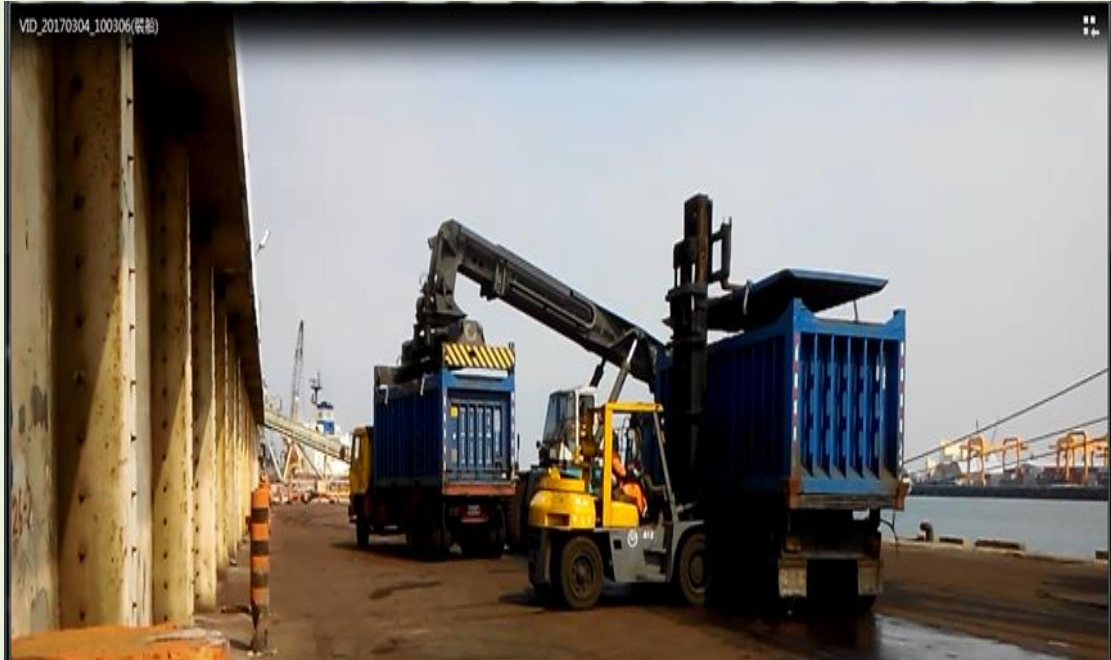
圖1 銅土出口裝船作業（圖右重櫃掀蓋，圖左空櫃上車。）
