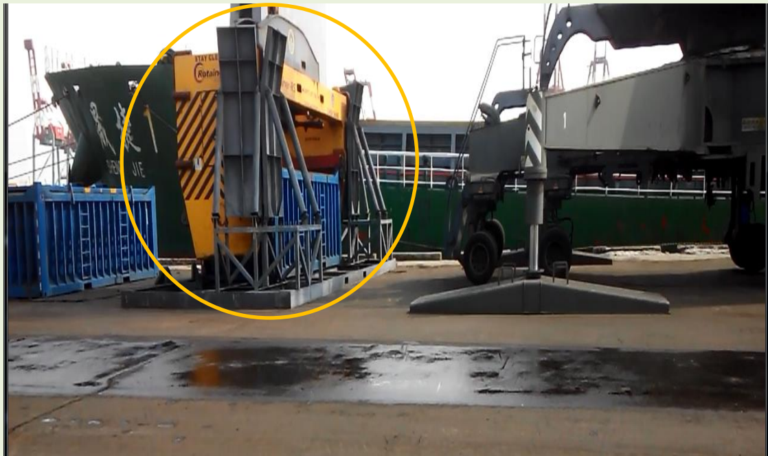
圖5 銅土出口裝船作業[夾具（圈示處）藉導正架，將重櫃夾緊後吊入船艙。]
