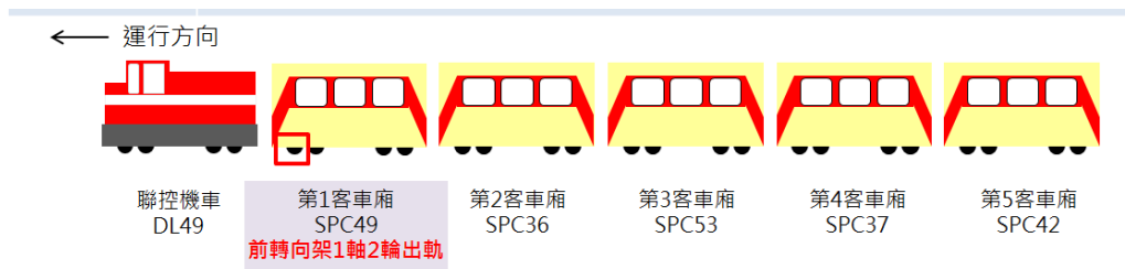
圖11 第1客車廂SPC49前轉向架1軸2輪出軌
